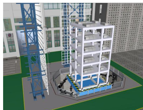
MTS 三向六自由度地震模拟振动台（5m ×5m）
